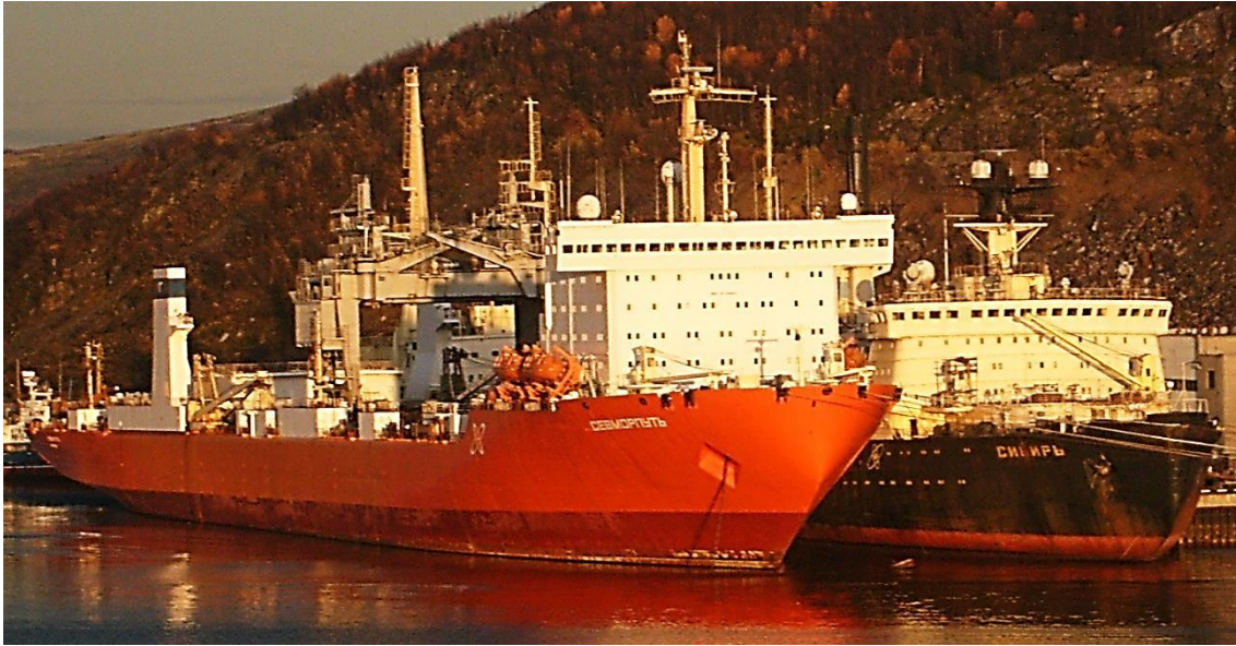
Barcos cuyos cascos, por debajo de la línea de flotación, están pintados con una capa protectora de color rojo. El crédito es para: Терский берег, CC BY-SA 3.0, https://commons.wikimedia.org/w/index.php?curid=9878791
