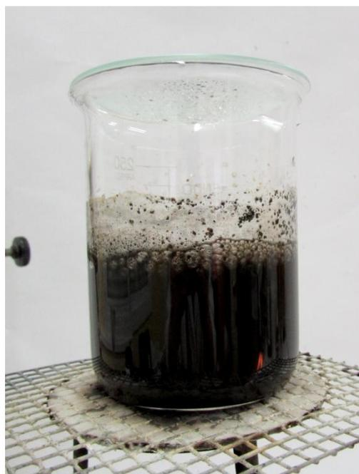
Podemos hacer un seguimiento del proceso de formación del óxido mixto a medida que la reacción se va desarrollando. A pesar de que a alta temperatura se aprecia un menor efecto de arrastre, la plasticidad del ferrofluido es bastante evidente.
