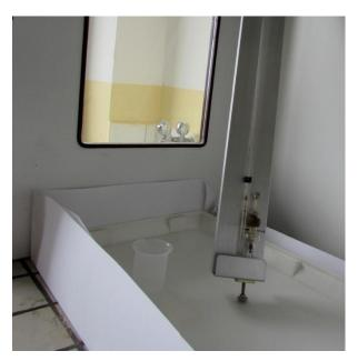
Antes de desenroscar la cubeta para recuperar el mercurio de la ampolla, hay que colocar la bandeja de plástico o de vidrio en el interior de otra hecha de papel, de una sola pieza, en el interior de la campana extractora. De ese modo si hubiera algún derrame, quedaría en la bandeja y podría recuperarse inmediatamente sin correr el peligro de que se derramase posteriormente por el interior de la campana.
