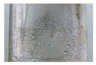
Se ve perfectamente la línea de altura máxima que alcanza el gas mercurio antes de condensar en gotas. En las paredes del vidrio, cuyo contacto con el exterior lo enfría antes que en el eje interior del tubo, se acumulan las gotas de mercurio destilado y puro.
