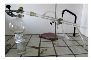
Los ajustes y los tapones se han protegido con grasa resistente a la temperatura. Además toda la destilación se ha llevado a cabo en la vitrina de gases, con guantes y con una mascarilla de protección adecuada<sup>8</sup>.
