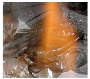
Para limpiar posteriormente el matraz o el tubo con derivación, una vez retirado con una espátula de cuchara el destilado, lo más adecuado es añadir azufre en polvo y agitar hasta que se adhiera por todas las paredes, salpicadas como estaban por una infinidad de gotitas minúsculas de mercurio. Unos cuantos días más tarde se raspa el interior y se confina el azufre con el mercurio en un recipiente hermético.
