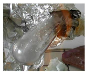
Como variante del proceso, podemos realizar la destilación usando un tubo con derivación lateral, que tiene un tramo mucho más corto entre el mercurio y la derivación lateral que encaja en el reflujo. Así el mercurio se puede calentar directamente en la misma salida lateral, facilitando mucho su destilado con goteo. En la imagen hemos apartado el papel de aluminio para apreciar el proceso.
