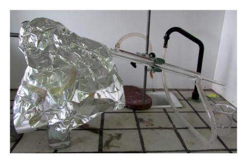
Así logramos obtener mercurio destilado y puro en la parte superior del matraz, así como en la parte inferior del tapón. Es fácil recuperarlo con una espátula pequeña de cuchara.
