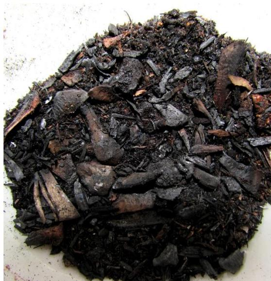
Una vez que tengo las cenizas producto del fuego, cargadas de inquemados, las molturaré en el mortero y volveré a quemarlo, tras lo que pasará la molienda a través de un tamiz que he elaborado agujereando con una aguja un trozo de papel de aluminio, para limitar el tamaño de partícula. Aquí vemos el resultado de la segunda combustión y el proceso de tamizado.
