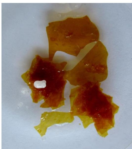
A medida que la goma laca se disuelve en el agua alcalinizada, la disolución se vuelve rosada hasta alcanzar un color intenso.
