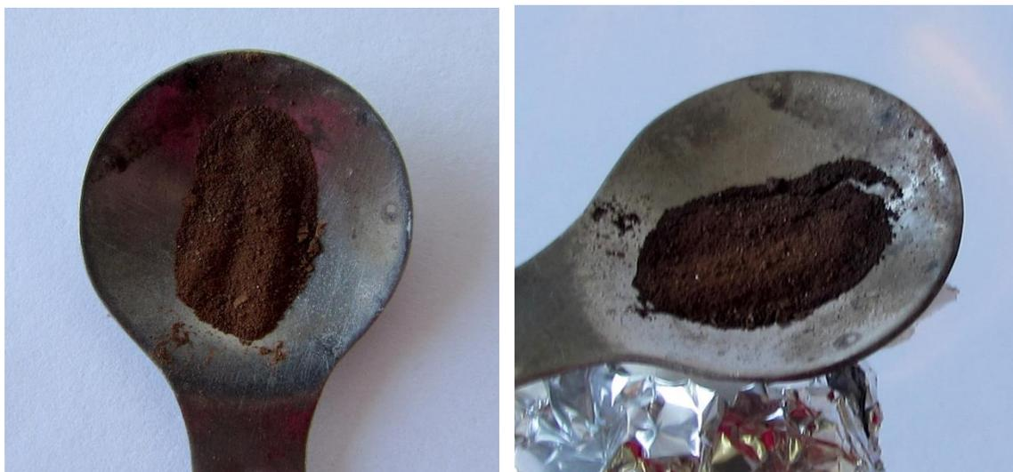
Comparemos el color del  $\text{Fe}_2\text{O}_3$  antes del calentamiento (a la izquierda) con el del  $\text{Fe}_2\text{O}_3$  después del calentamiento (a la derecha). La diferencia es sustancial y probablemente fue una técnica sistemática en el Egipto Antiguo, aunque habría que investigar esto con mayor profundidad. Al calentar a alta temperatura y deshidratarse la sustancia, puede volverse a molturar de forma más eficiente y eso se nota en el polvo que queda adherido al vidrio de reloj.
