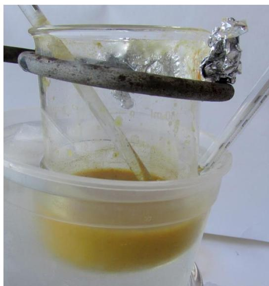
He devuelto al vaso de precipitado las aguas madres y esto es una imagen del resultado. El compuesto se ha debido de protonar y se ha solubilizado en parte, cambiando su estructura electrónica de modo que ahora, el color que refleja, está en la franja de los rojos, algo muy típico de los tintes diazo, que cambian su color con el pH, lo que da pie a su uso como indicadores ácido-base, como es el caso del naranja de metilo o el Rojo Congo, entre otros.
