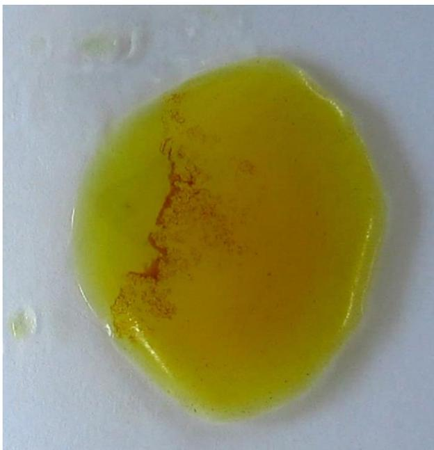
Una vez disuelta la anilina amarilla en unos 2mL de alcohol añado 0,25 de goma arábica y agito suavemente con una varilla de vidrio. La disolución se logra sin ningún problema, a pesar de la tendencia a formar grumos del aglutinante.
