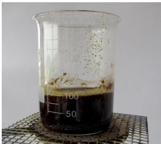
El color de la disolución se torna pardo oscuro a causa de los taninos que quedan en disolución. Se hubiera podido filtrar la mezcla como se hizo con la receta de la tinta ferrogálica, pero en esta receta concretamente no indican nada al respecto. Tras unos 5 minutos hirviendo le he echado 1,8 gramos de  $\text{FeSO}_4$  y se aprecia el cambio de color de pardo a azul oscuro de forma casi instantánea. A medida que pasa el tiempo el color azul va dando paso al negro intenso.
